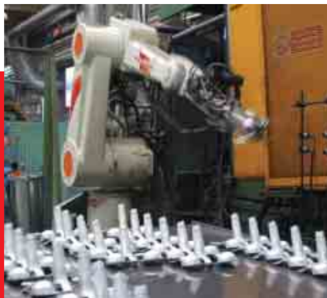
4. Robot adibito alla macchina di pressofusione 4. Robot arranged for die-casting machine
